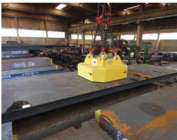
Le traverse elettropermanenti telescopiche possono assumere dimensioni longitudinali diverse, dai 6 ai 16 metri, in base alle dimensioni delle lamiera da movimentare
