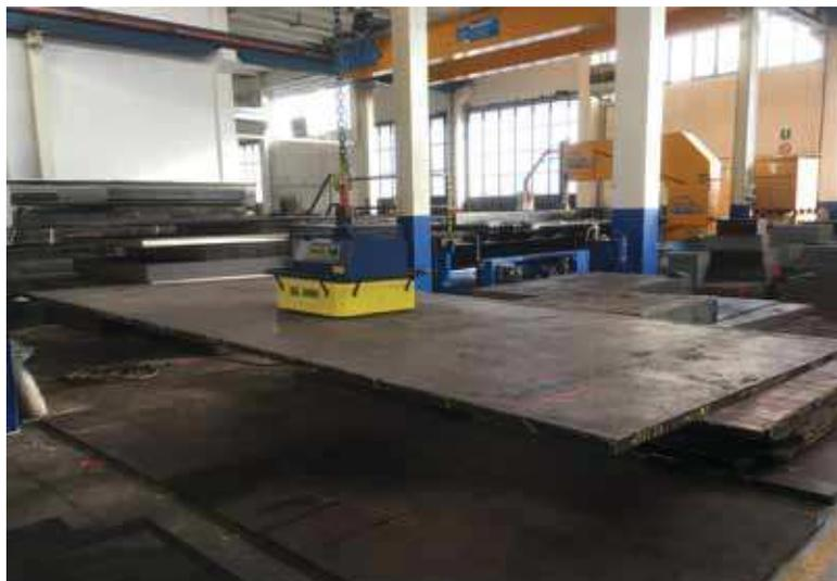
A sinistra: il sollevatore elettropermanente a batteria prodotto dalla S.P.D.
