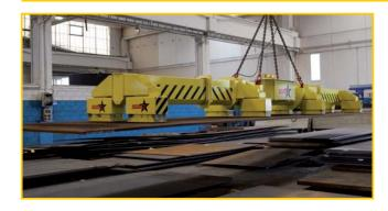
Traverse fisse e telescopiche in grado di manipolare tutte le dimensioni di lamiere, sia di piccolo (2mm) che di grande spessore.
