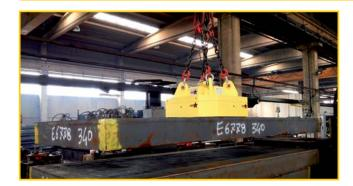
I sollevatori SEP sono stati ideati per la movimentazione di bramme e blocchi fucinati con elevati traferri.
