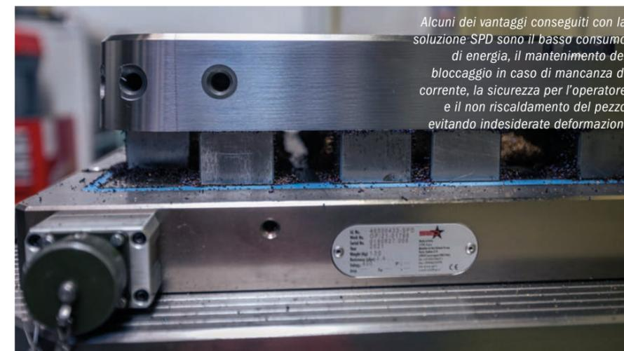
*Alcuni dei vantaggi conseguiti con la soluzione SPD sono il basso consumo di energia, il mantenimento del bloccaggio in caso di mancanza di corrente, la sicurezza per l'operatore e il non riscaldamento del pezzo evitando indesiderate deformazioni*
