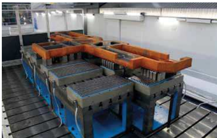
I piani magnetici a polarità quadra della S.P.D., standard e speciali, consentono il bloccaggio sicuro dei pezzi di qualsiasi forma, dimensione e spessore su macchine utensili, in particolare fresatrici e rettificatrici
