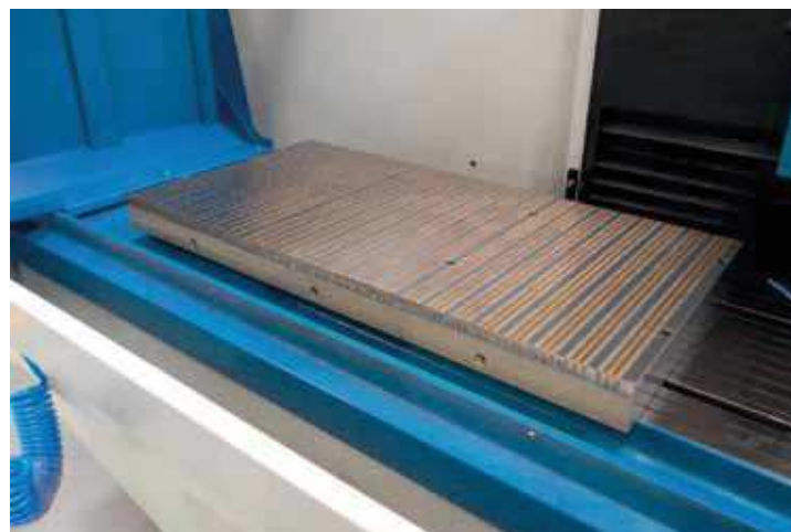
Altri due esempi di applicazione dei sistemi magnetici elettropermanenti della S.P.D. in ambito fresatura e rettifica
