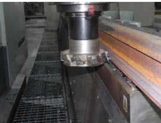
A sinistra: fase di lavorazione della suola A destra: seconda lavorazione del fungo. Operazione che richiede un bloccaggio sicuro
