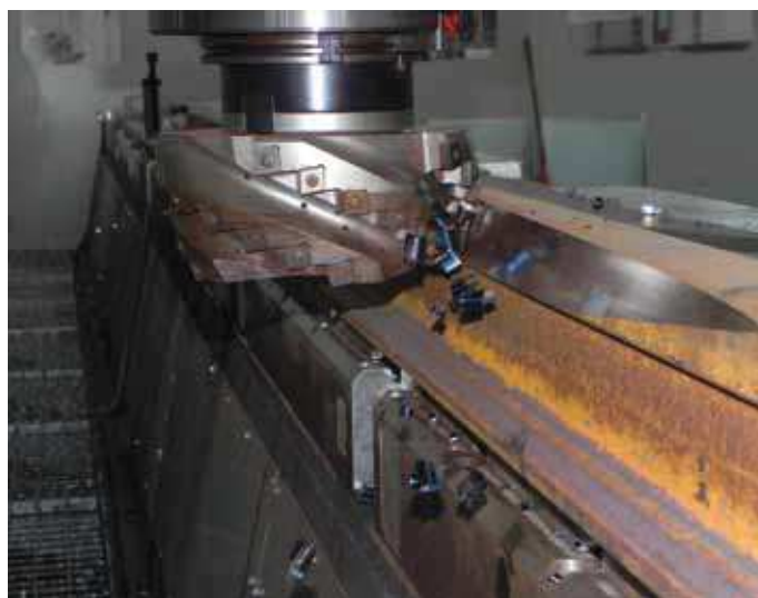
A sinistra: prima lavorazione del fungo della rotaia A destra: profilo di una rotaia lavorato in un solo posizionamento
