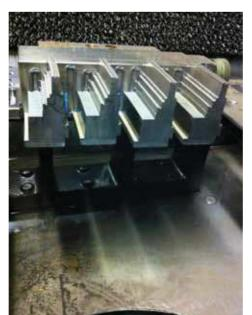
A sinistra: modulo per elettroerosione a filo; posizionamento di più pezzi contemporaneamente A destra: esempio di applicazione di un prodotto S.P.D. nel campo della robotica
