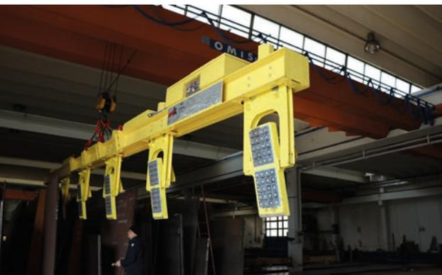
TREFIX - V, soluzione che consente di portare la lamiera dalla posizione orizzontale a quella verticale, molto utile in magazzini che non hanno a disposizione ampio spazio a terra
