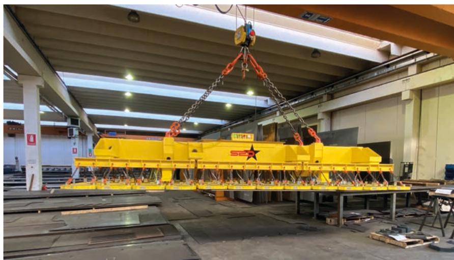
TREFIX - T, una traversa per il carico e lo scarico di impianti di taglio
