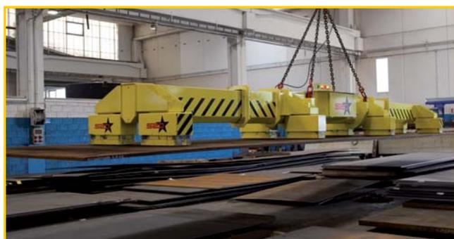
Traverse fisse e telescopiche in grado di manipolare tutte le dimensioni di lamiera, sia di piccolo (2mm) che di grande spessore.
