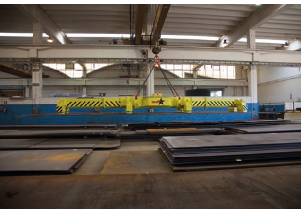
Fase di movimentazione di lamiera con bracci telescopici aperti
