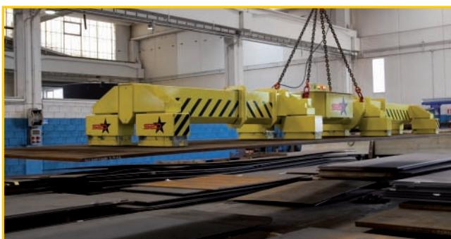
Traverse fisse e telescopiche in grado di manipolare tutte le dimensioni di lamiere, sia di piccolo (2mm) che di grande spessore.
