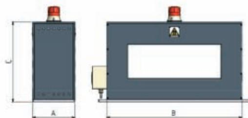
È l'accessorio più potente sul mercato per la smagnetizzazione di qualsiasi pezzo che abbia residuo magnetico difficilmente eliminabile, con la semplice operazione di far passare una o più volte il pezzo attraverso il foro o tunnel di demagnetizzazione.
