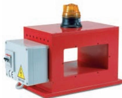
**Soluzione con passaggio di demagnetizzazione circolare**
