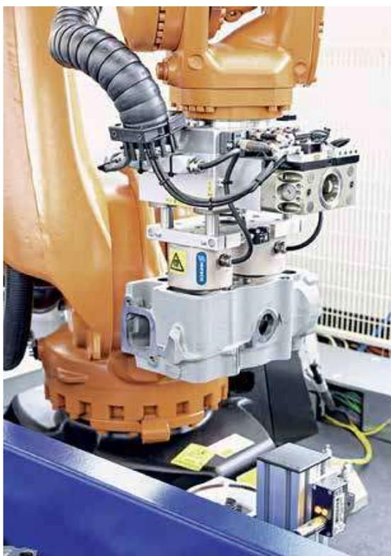
A sinistra, moduli magnetici elettropermanenti EGM usati per la pallettizzazione di teste cilindro. I moduli EGM possono essere posizionati a scelta sui pezzi in varie combinazioni per formare unità di presa più grandi
