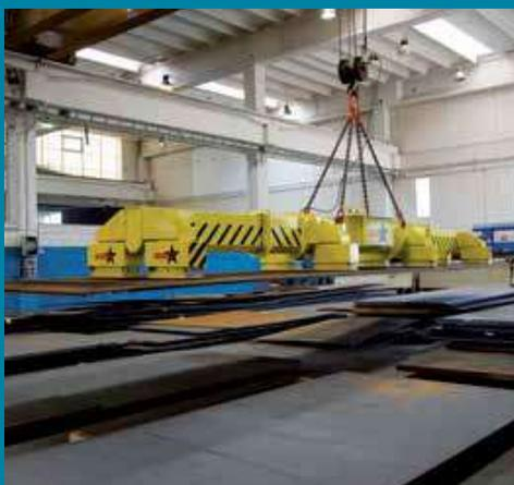
**C.** Le traverse Trefix-T non richiedono l'installazione di batterie tampone; sono dotate di sistema antisattivazione accidentale. Inoltre, offrono la possibilità di selezionare la magnetizzazione dei moduli a seconda delle dimensioni del carico.
