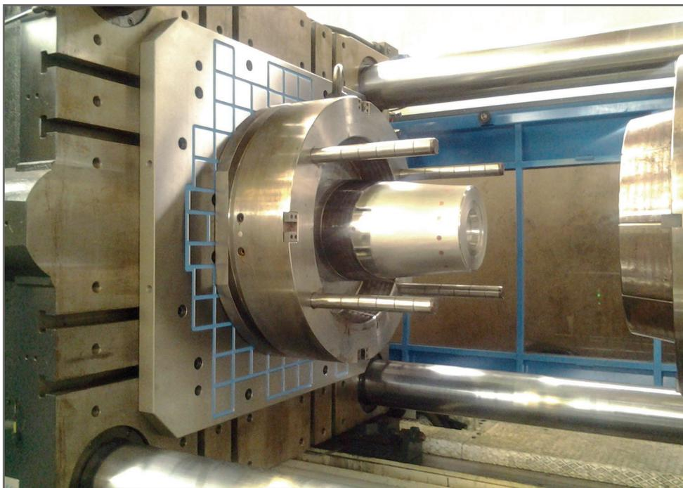
Il sistema SYMPLI è costituito da moduli magnetici realizzati disponendo all'interno di una robusta struttura di acciaio magneti AlNiCo e neodimio di alta qualità.
