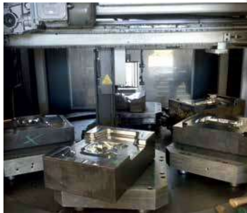
Il piano Magnetico L30 si adatta molto bene a stampi di dimensione e spessore abbastanza contenuti attorno a 150x150 mm, o anche meno.
