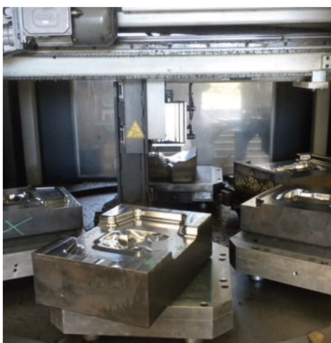
Il piano magnetico L30 a polo parallelo si adatta molto bene a stampi di dimensione e spessore abbastanza contenuti attorno a 150x150 mm, o anche meno
