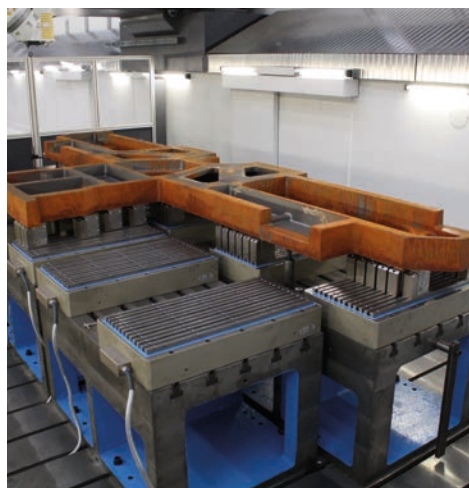
Sopra: bancata piani fresa a poli paralleli con spessorazione automatica
