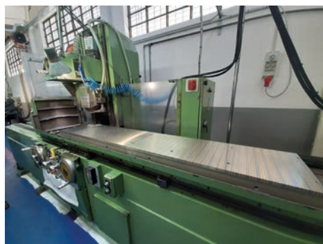
Piano elettropermanente per rettifica PM60D con ciclo di smagnetizzazione e passo polare fine con struttura ferro e ottone
