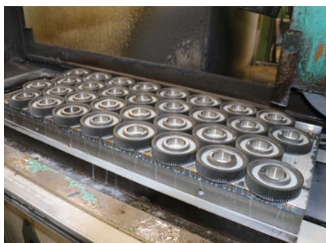
Grazie alla lunga esperienza nel settore magnetico, SPD è in grado di realizzare soluzioni per la rettifica sfruttando le potenzialità della tecnologia elettropermanente
