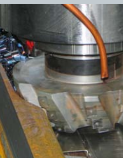
Prima lavorazione del fungo della rotaia. A destra: profilo di una rotaia lavorato in un solo posizionamento.
