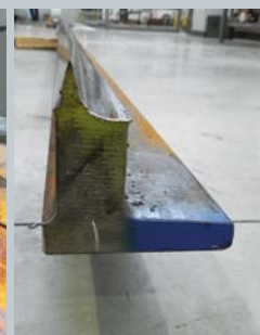
Prima lavorazione del fungo della rotaia. A destra: profilo di una rotaia lavorato in un solo posizionamento.
