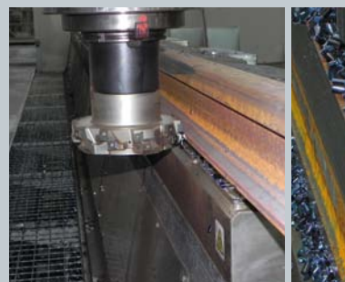
Fase di lavorazione della suola. A destra: seconda lavorazione del fungo. Operazione che richiede un bloccaggio sicuro.
