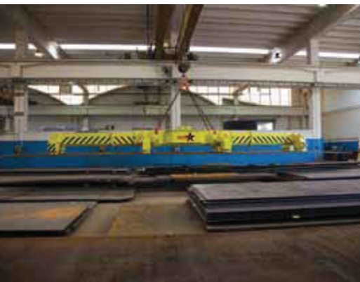
La traversa telescopica Tretel in azione con bracci telescopici aperti e bracci telescopici chiusi
