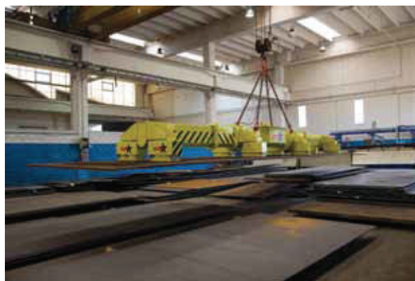
A sinistra: Tretel è in grado, quando necessario, di sollevare lamiera mettendo in azione solo le teste laterali A destra: traversa telescopica elettropermanente Tretel realizzata dalla S.P.D.
