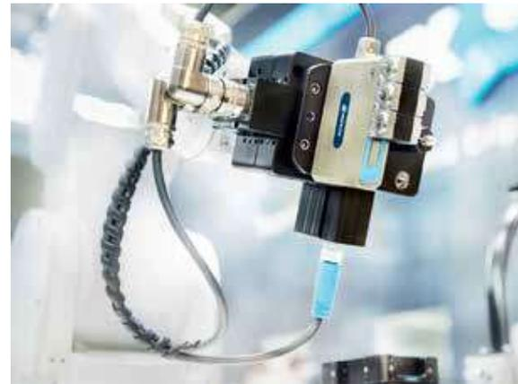
*Modulo di presa magnetico elettropermanente*
