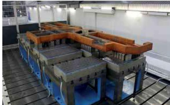
*Bancata di una fresa a polo parallelo con spessorazione automatica*
