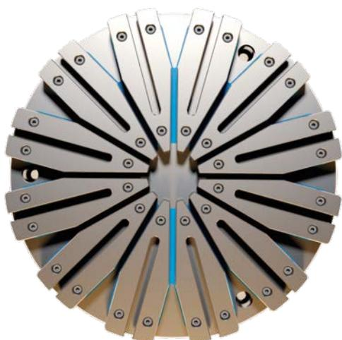
La polarità radiale garantisce il corretto bilanciamento polare per il bloccaggio di pezzi come anelli dischi anche di geometria difficili.
