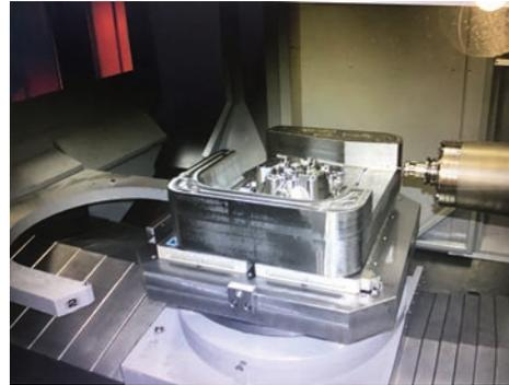
*D sinistra: piani magnetici SPD, modello MFR A1 070, per ancoraggio di particolari con elevato spessore*
