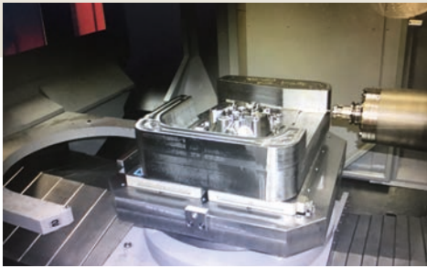
Piano elettropermanente MFR-A1-050 su centro di lavoro per fresatura stampi realizzato da SPD
